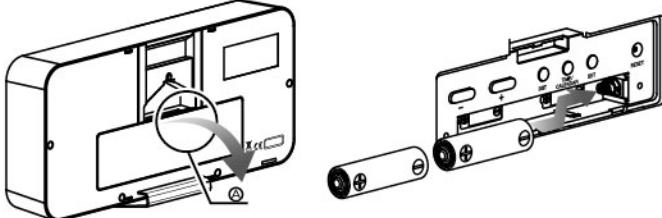
②對準電池槽內刻印的電池記號(□□)，注意(+)不要裝反，將第1個電池從左側放入後滑向右側，接著放入第2個電池。
