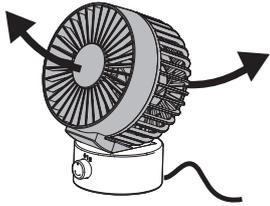
風向可由水平方向向上調整至約30度的範圍。調整時請以單手扶住底座再調整。調整前，請務必確認開關切換於「0」（關）的位置。※於扇葉旋轉時移動前後網罩，可能導致扇葉與網罩碰觸。
