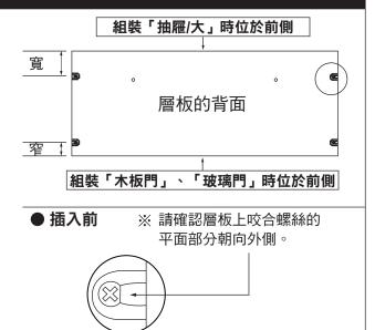
對齊圖層板內側的支撐部份與圖層板固定螺絲的位置,安裝層板。 最後請輕輕拍打層板。確實扣入@層板固定螺絲。 過度拍打放入的話可能會損壞,敬請注意。
