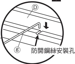
① 將⑧防開鋼絲插入④側軌的承托橫樑的防開鋼絲安裝孔。
