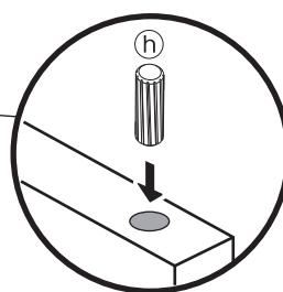
② 將⑨木栓插入④側軌的承托橫樑的木栓安裝孔。
